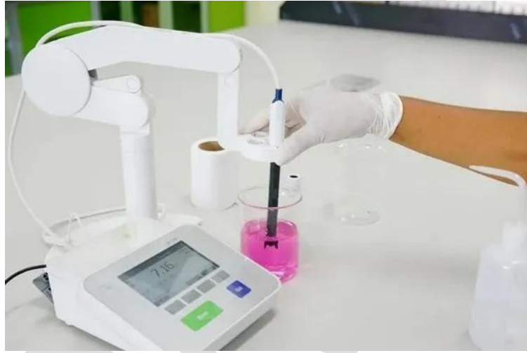
Şekil 4. Boya numunesi pH analizi
